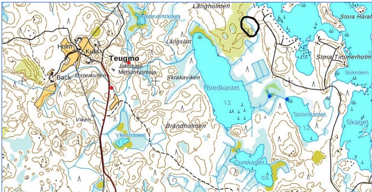
Kuva 5.2.25. Bredkastetin–Strömkastetin järvesistö Teugmossa. Punaisilla pisteillä on merkitty vesistöä eniten happamoittavat sivupurot. Sinisillä pisteillä on merkitty potentiaaliset vaellusesteet ja mustalla ympyrällä on merkitty Bredkastetin laskupurossa kohta, johon on suositeltavaa rakentaa levähdyspaikkoja kaloille esimerkiksi asettamalla kiviä puroon. (Kartan tiedot perustuvat maanmittauslaitoksen maastotietokantaan 10/2020)
